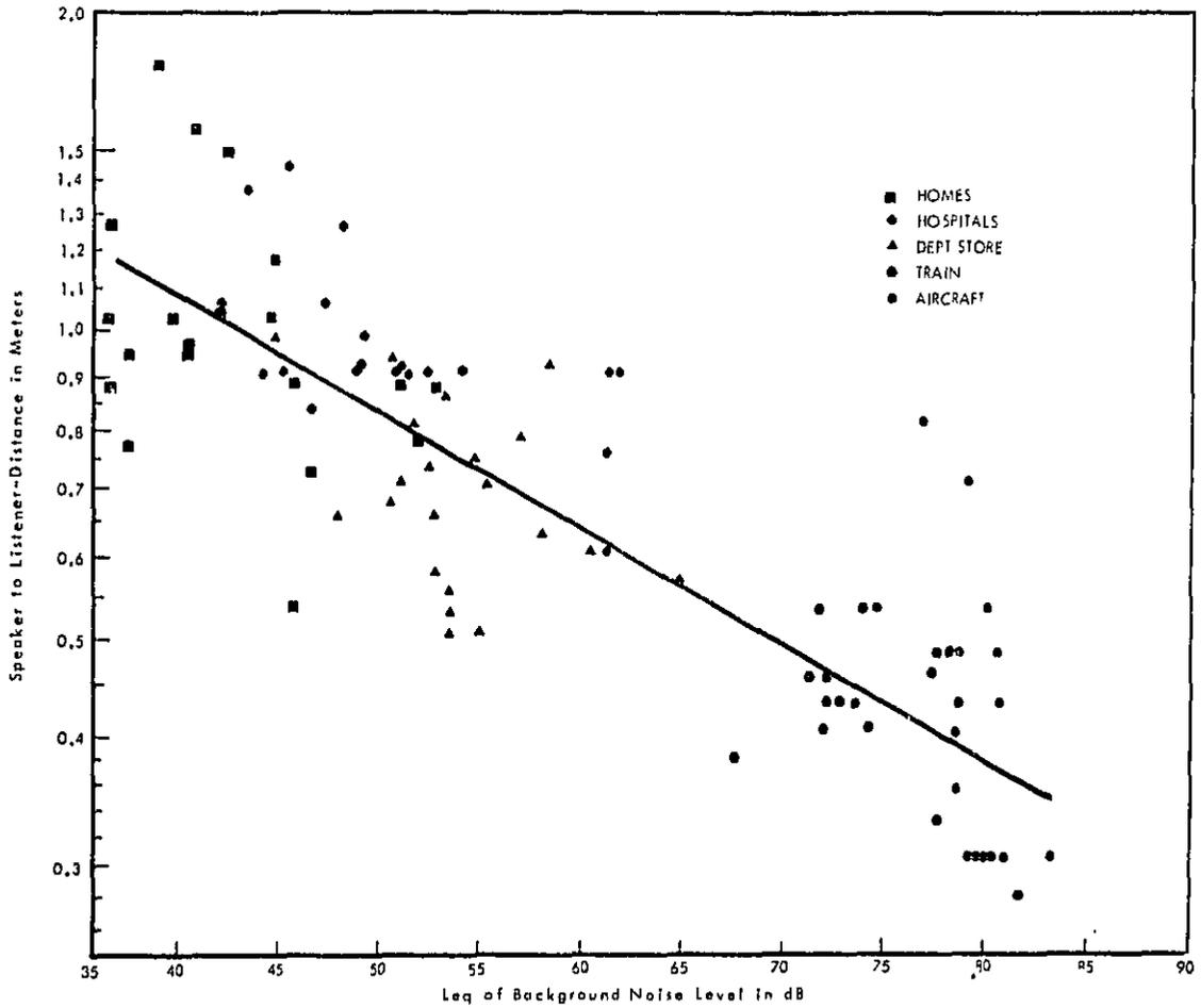
FIGURE 22. INTERPERSONAL DISTANCE OBSERVED FOR CONVERSATIONS AS A FUNCTION OF BACKGROUND LEVEL IN VARIOUS ENVIRONMENTS
