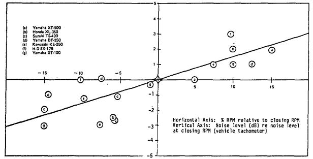
FIGURE I~2 NOISE LEVEL AS A FUNCTION OF CLOSING RPM COMBINATION MOTORCYCLES
